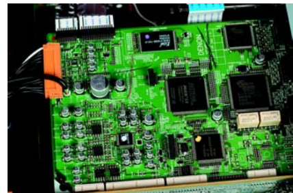
Główny druk cyfrowy skupia obwody audio i wideo, co wraz z bezpośrednim łączeniem płytek pozwoliło ograniczyć okablowanie.
