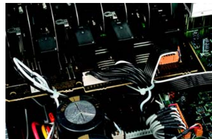
Gniazda głośnikowe kluczowane przekaźnikami, ale przeniesione poza płytkę końcówek mocy i podłączone przewodami.
