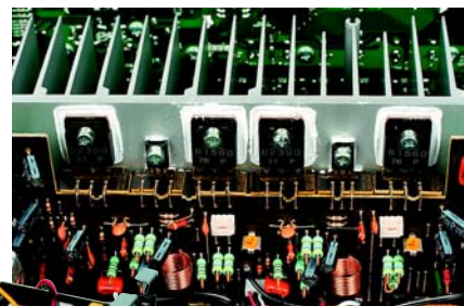
Ciekawa aranżacja końcówek - dwie na górze (widoczne na zdjęciu), pięć na dole radiatora, pozwalająca efektywniej wykorzystać jego powierzchnię.
