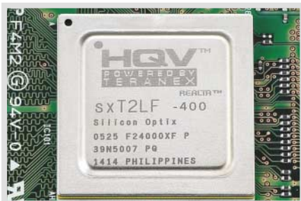
Czytelny podział na poszczególne sekcje zdradza klasę i cenę DVD-3930. Procesor wizyjny HQV znajduje się pod radiatorem, umieszczonym za czytnikiem S.V.H. produkcji Denona
