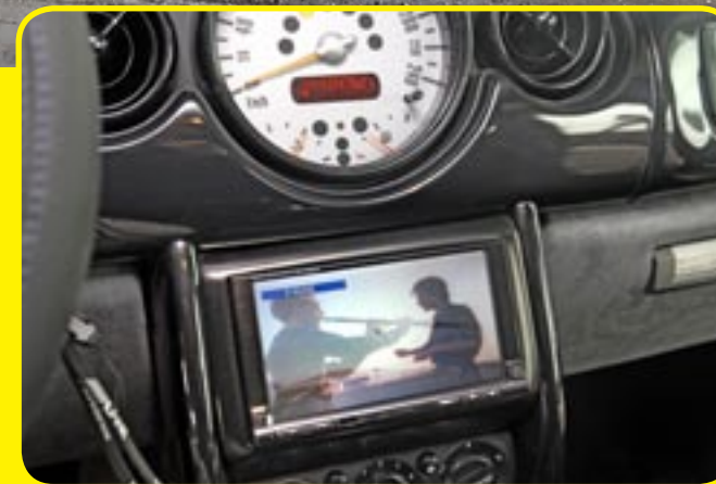
Serce systemu stanowi stacja multimedialna IVA-W202R z 6,5-calowym ekranem dotykowym umieszczona tuż pod prędkościomierzem
