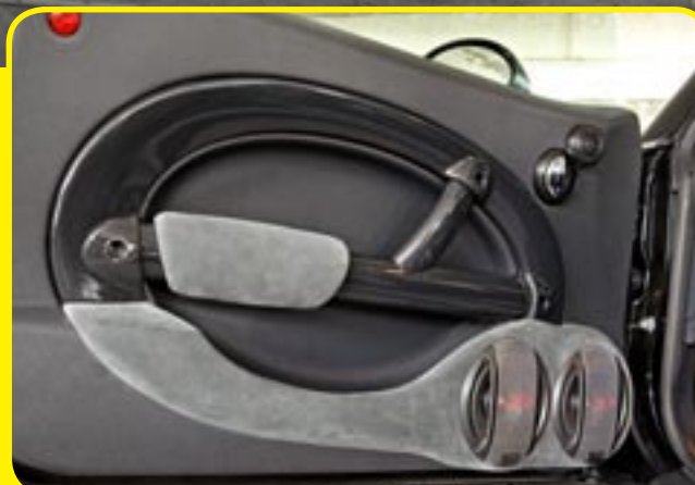
W zmodernizowanym panelu drzwiowym zmieściły się dwa 2-drożne głośniki komponentowe SPR-17S
